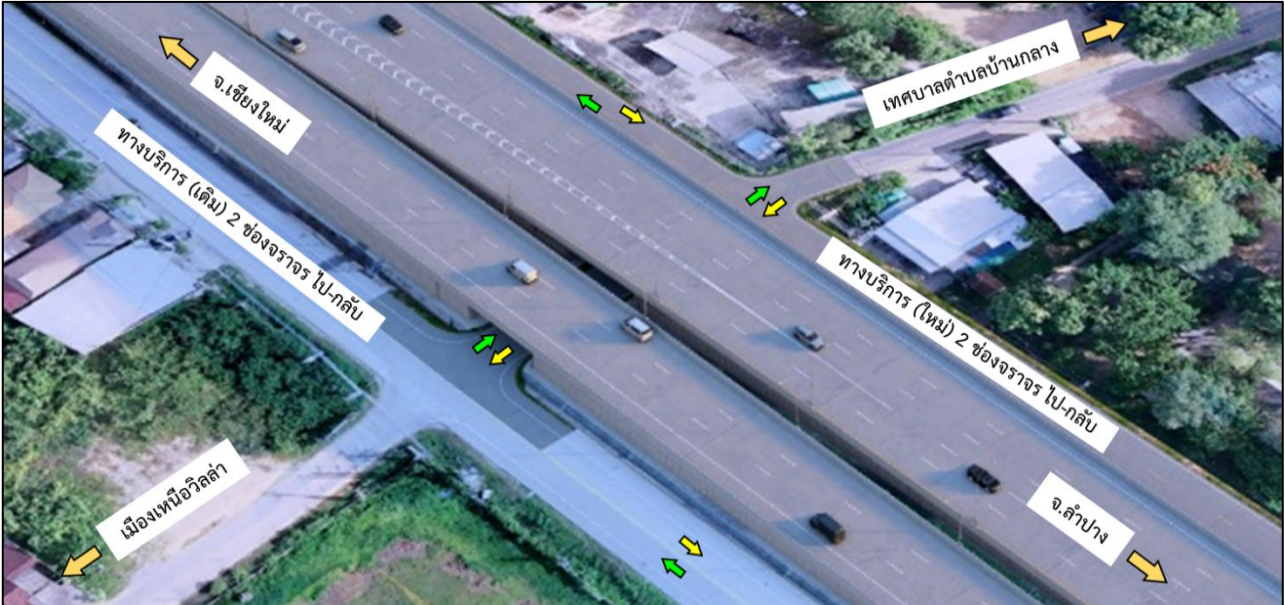
รูปที่ 8 รูปแบบทางลอดทางหลวงหมายเลข 11 สำหรับคนเดินและรถยนต์
