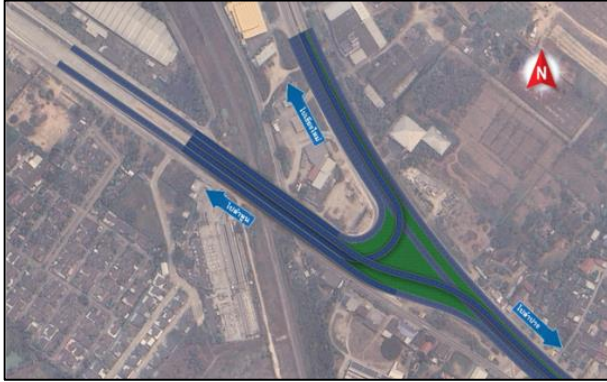
ทางแยกต่างระดับรูปตัววาย (Y-Interchange)
